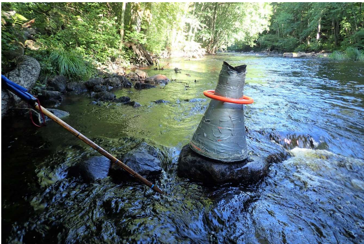
Figur 3. Bilden visar vattenkikare med kombinerad inventeringsstav och musseltång som användes vid inventeringen. Foto per Ingvarsson.
